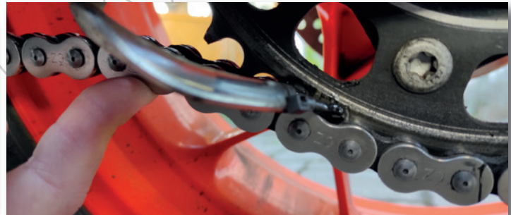
Bild 36 Falsche Düsenposition: die Kette berührt die Düse.
