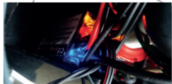
Die gelbe, rote und blaue LED leuchtet nach Motorstart an der Steuerung.
