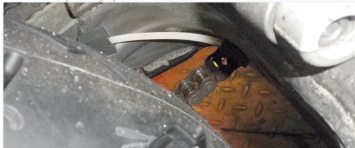
Bild 41 Ölleitung an der Innenseite der Schwinge verlegt
