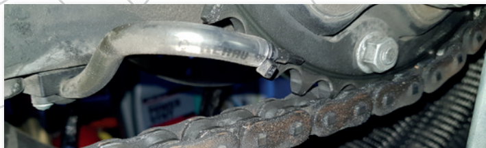
Bild 23 Montage der Ölleitung Einarmschwinge, Düse auf Außenseite
