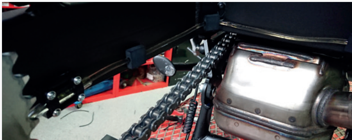
Bild 26 Ölleitung an der Innenseite der Schwinge
