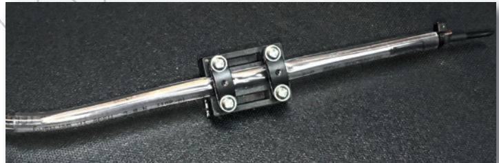
Bild 16 Ölleitung im Halteklotz
