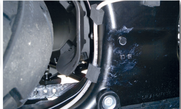
Bild 27 Verlegung der Ölleitung an der Schwingen Innen- und Unterseite
