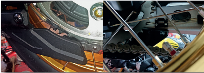
Bild 25 Montage Halteklotz an der Innenseite der Schwinge, Düse auf Außenseite am Kettenrad
