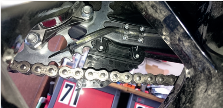
Bild 37 Richtige Düsenposition: die Düse ist nicht zu weit vom Auflaufpunkt der Kette auf das Kettenrad entfernt.
