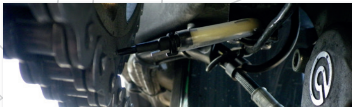
Bild 22 Montage der Ölleitung, Einarmschwinge, Düse auf Innenseite
