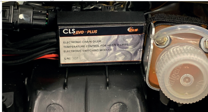
Bild 7 Tank im Aluhalter liegend verbaut
