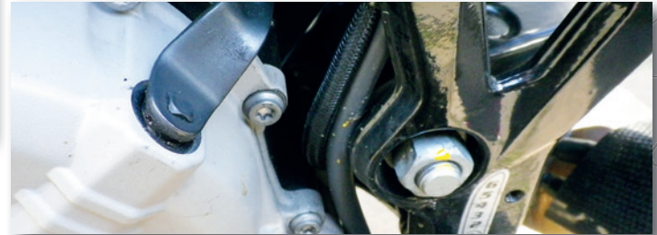
Bild 45 Ölleitung an der Husqvarna Nuda 900 am Schwingendrehpunkt im Sichtbereich, daher mit Geflechschlauch überzogen
