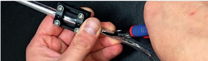
Bild 17 Parallel zum Stahldraht den Oberschlauch einschneiden und bis auf die gewünschte Länge aufschneiden
