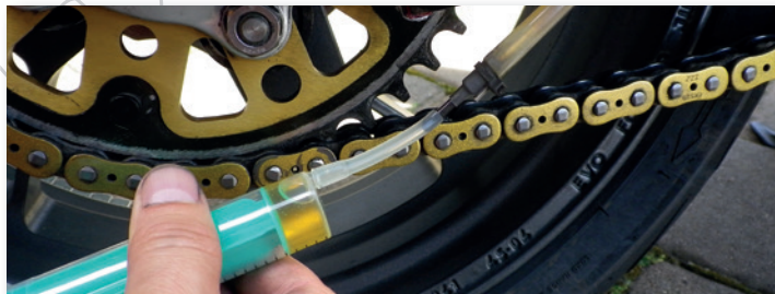
Bild 47 Einwegspritze mit Silikonschlauch auf Düse gesteckt und Ölleitung entlüftet
