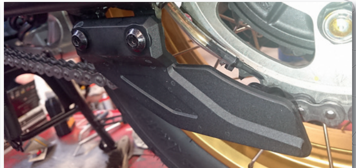
Bild 39 Richtige Düsenposition: die Düse läuft auf dem Absatz des Kettenrades.
