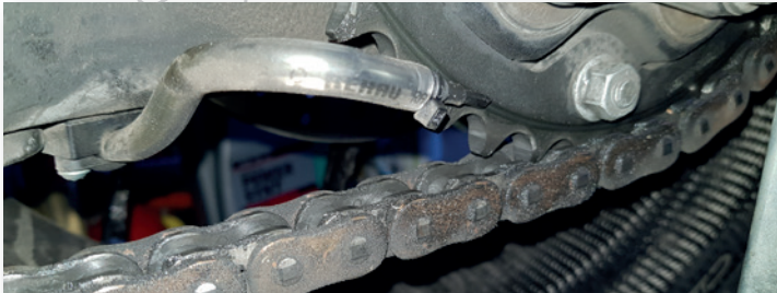
Bild 34 Montage der Ölleitung Einarmschwinge, Düse auf Außenseite
