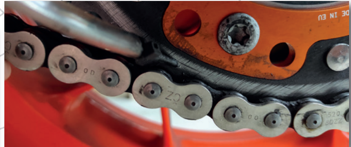
Bild 35 Korrekte Düsenposition: die Kette kann die Düse nicht berühren.
