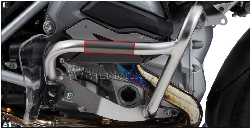
LACKSCHUTZFOLIE NUR IM ÄUßEREN BEREICH DES STURZBÜGELS VERWENDEN!
