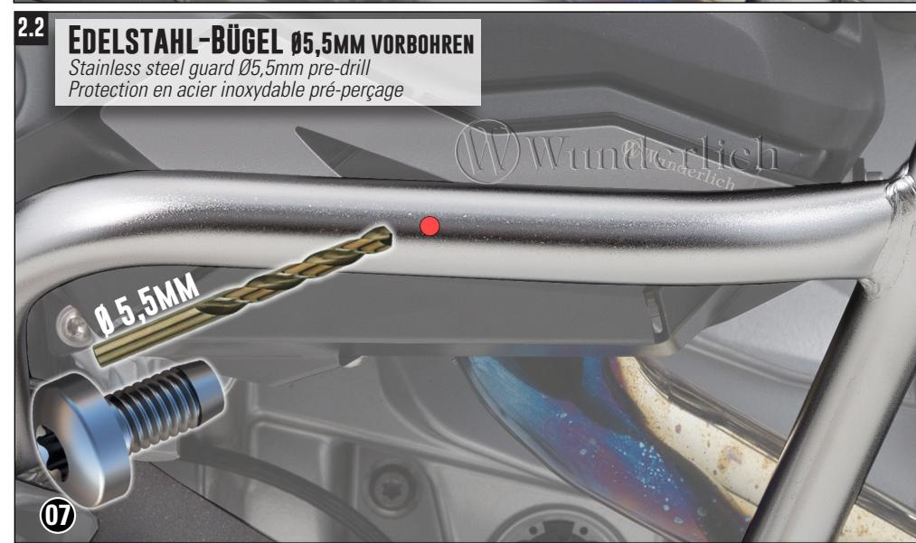
**WIR EMPFEHLEN FÜR DEN ARBEITSSCHRITT „BOHREN“, DEN STURZBÜGEL ZU DEMONTIEREN. IM MONTIERTEM ZUSTAND BOHREN, SCHÜTZEN SIE DEN DAHINTER LIEGENDEN MOTOR BZW. DIE VENTILDECKEL.**
