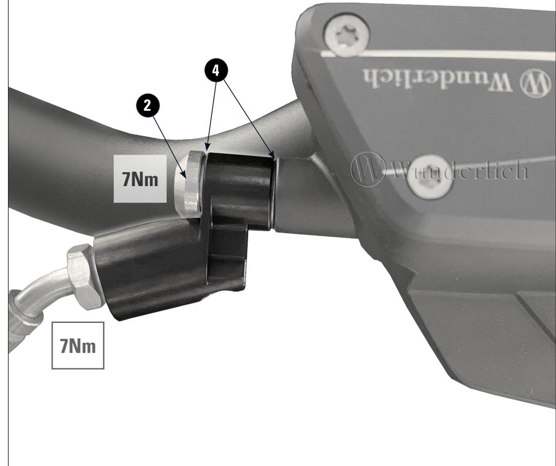
**Die Brems.- und Kupplungsleitungsadapter montieren und nach Herstellerangaben entlüften.**
