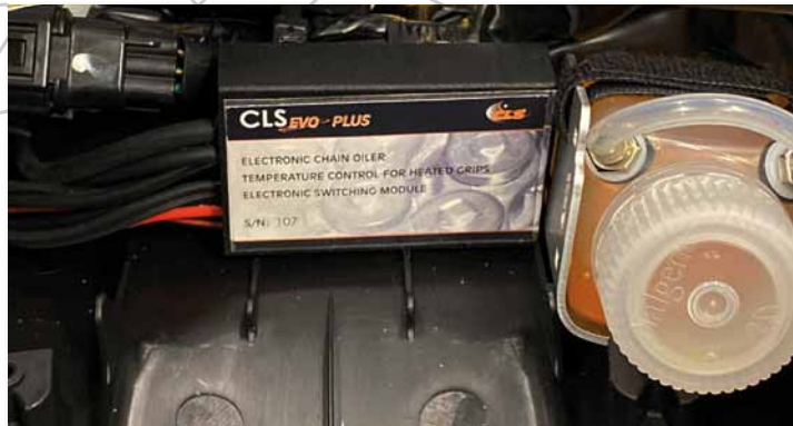
Bild 7 Tank im Aluhalter liegend verbaut
