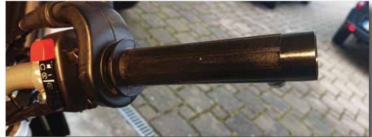
Bild 41 Gasgriffhülse ohne Griffgummi
