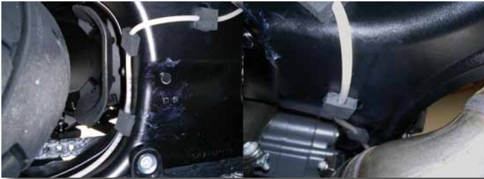
Bild 34 Verlegung der Ölleitung von der Innenseite der Schwinge über die Schwingenbrücke auf die nicht kettenführende Unterseite der Schwinge
