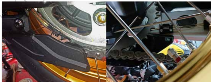
Bild 24 Montage Halteklotz an der Innenseite der Schwinge
