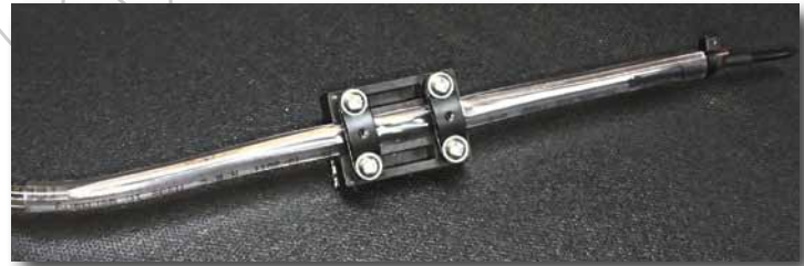
Bild 16 Ölleitung im Halteklotz
