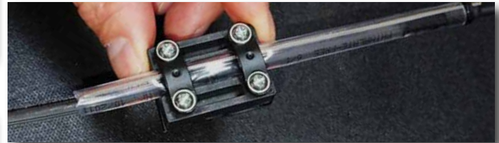
Bild 20 Einbau bei Einarmschwingen oder bei der Montage des Halteklotzes an der Innenseite der Schwinge. Legen Sie die Ölleitung so in den Halteklotz, dass die Ölleitung etwa zwei Finger breit nach hinten aus dem Halteklotz übersteht.
