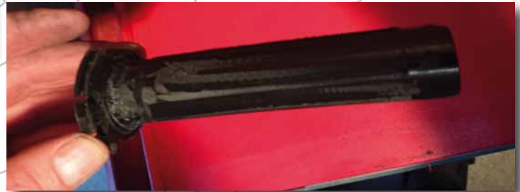
Bild 43 Gasgriffhülse teilweise geschliffen
