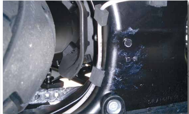
Bild 26 Verlegung der Ölleitung an der Schwingen Innen- und Unterseite
