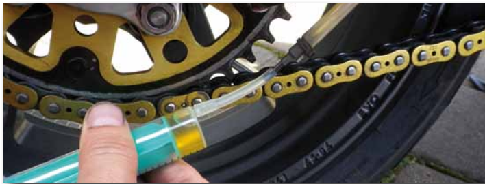
Bild 39 Einwegspritze mit Silikonschlauch auf Düse gesteckt und Ölleitung entlüftet
