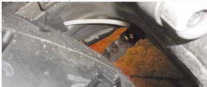
Bild 33 Ölleitung an der Innenseite der Schwinge verlegt
