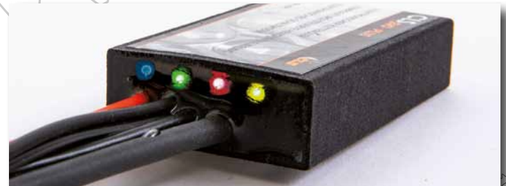
Bild 5 LEDs an der Steuerung
