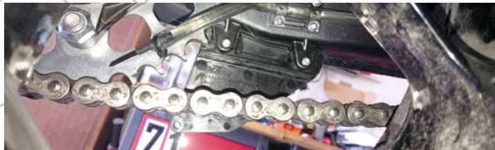
Bild 23 Montage Halteklotz Zweiarmschwinge Düse Innenseite
