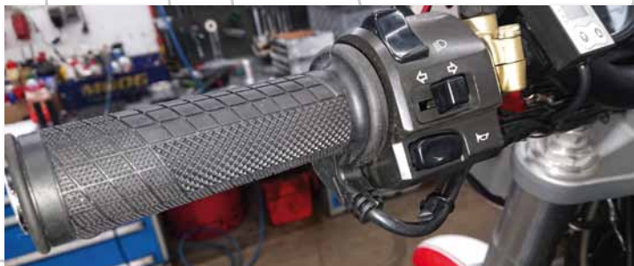
Bild 45 Ducati Monster S4R: Heizgriff links und Temperatursensor
