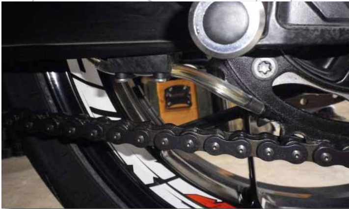
Bild 28 Halter unter der Schwinge. Düse von außen ans Kettenrad
