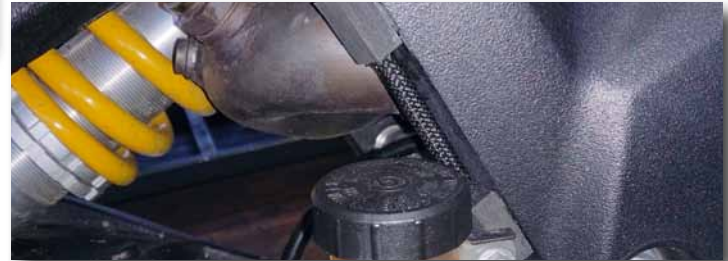
Bild 36 Ölleitung an einer Ducati Monster 1100 EVO, zwischen den Halteklötzen mit Geflechschlauch überzogen
