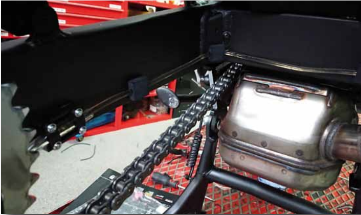
Bild 25 Ölleitung an der Innenseite der Schwinge
