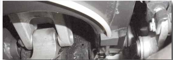
Bild 27 Führung der Ölleitung unter der Schwinge um den Schwingendrehpunkt herum
