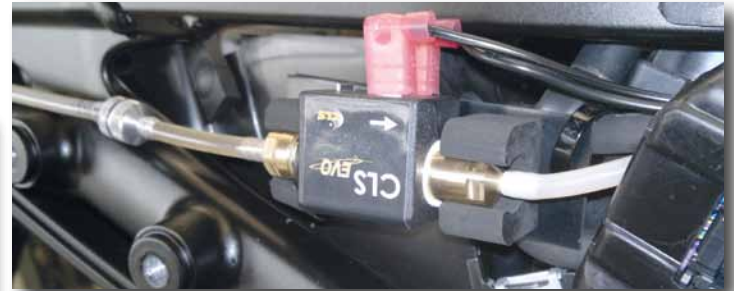
Bild 10 Gummihalter der Pumpe an der Halteplatte verklebt, Halteplatte mit Kabelbindern am Motorrad befestigt.
