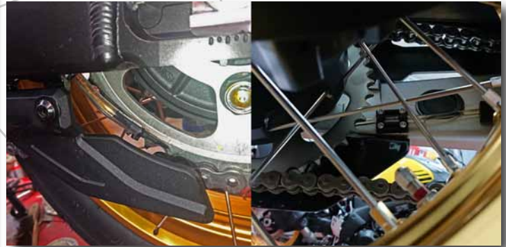
Bild 29 Hier sieht man den innen angeklebten Halteblock
