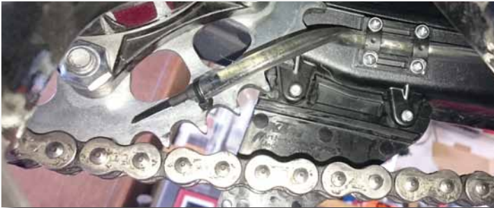
Bild 30 Ölleitung im Bogen um das Kettenrad herumgeführt. Düse an der Rückseite des Rades angelegt.
