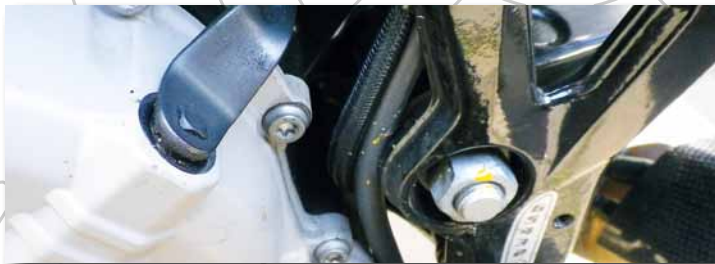
Bild 37 Ölleitung an der Husqvarna Nuda 900 am Schwingendrehpunkt im Sichtbereich, daher mit Geflechtschlauch überzogen
