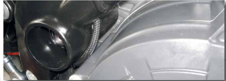
Bild 35 Ölleitung am Schwingendrehpunkt zur Tarnung mit schwarzem Gewebeschlauch überzogen
