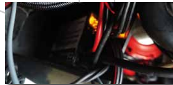
Die gelbe LED leuchtet beim Programmieren der Nachlaufzeit.
