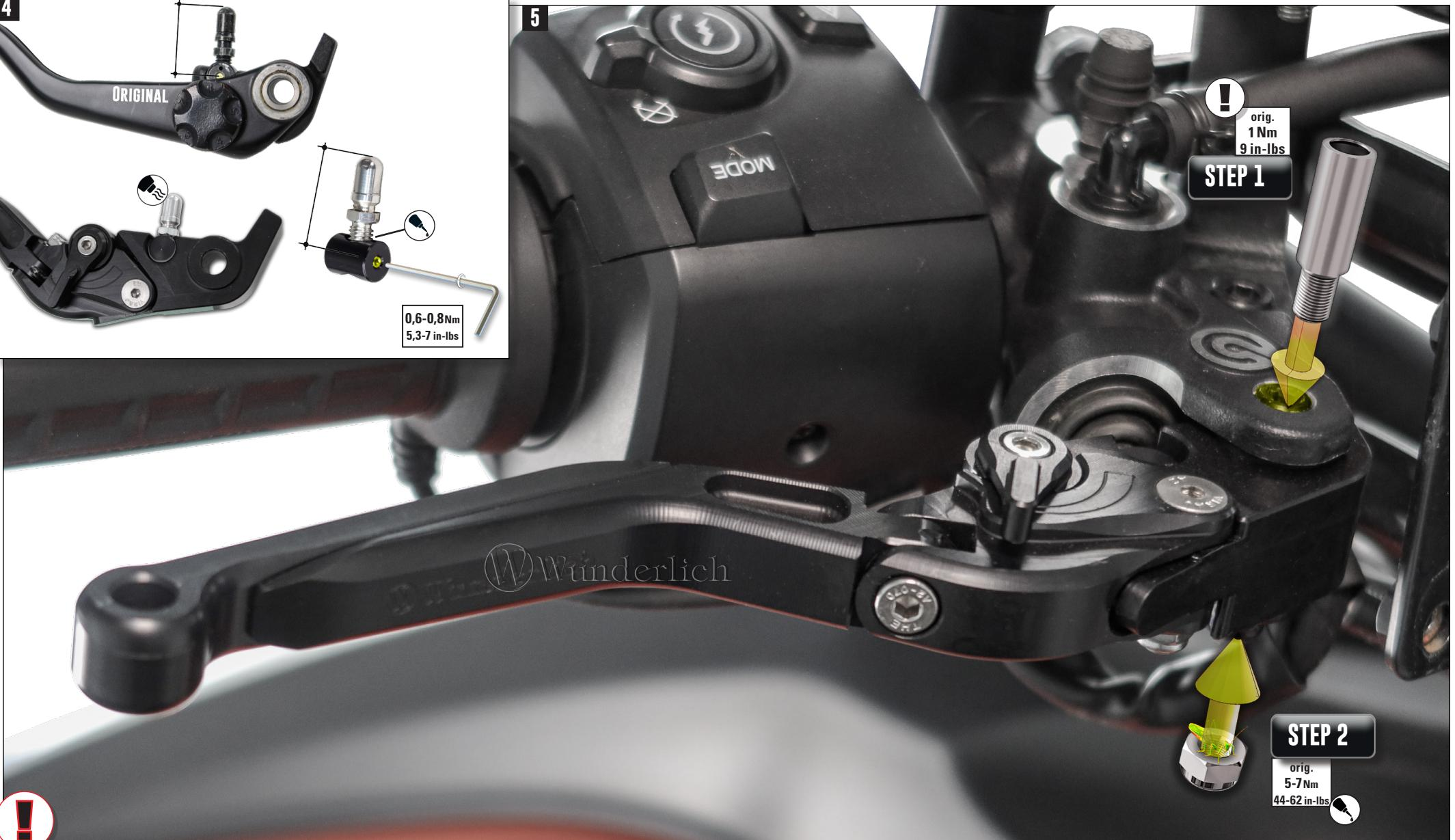
**Übernehmen Sie die Einstellung des orig. Bremspumpenstifts (Bild4). Achtung, Leerweg und Lüftspiel überprüfen. Die Bremsscheiben müssen frei drehen. Danach den Bremspumpenstift mittels der Madenschraube fixieren.**
